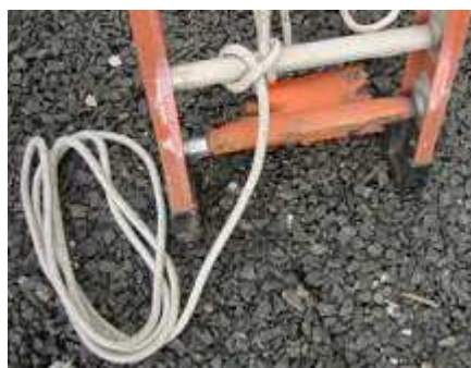
Figura 17 - Nó fiel na base da escada
