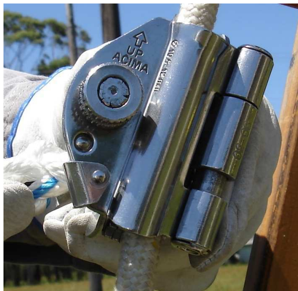
Figura 30 - Fechamento e travamento do trava-quadras
