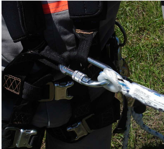
Figura 28 - Instalação do trava-quadras no cinto paraquedista
