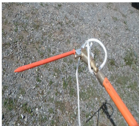
Figura 24 - Instalação do agulhão no cabeçote da vara de manobra
